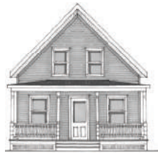
Disposition symétrique des ouvertures
